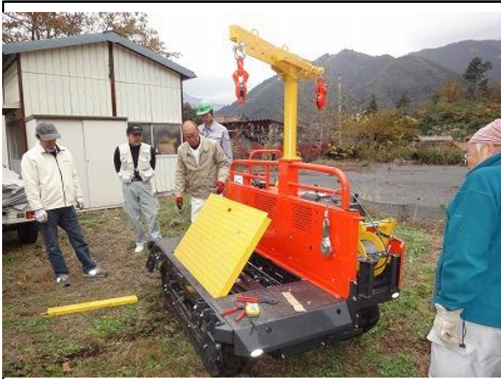
ダンプ機能、積込んだ材を一気に荷下します
