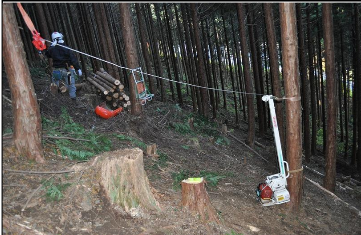
滑車による方向転換で、真横から集材
